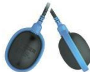
В поплавковом переключателе шарик перемещается в соответствии с положением поверхности жидкости, тем самым приводя в действие высококачественное микрореле. Углубленная поверхность для перемещения шарика обеспечивает бесперебойную работу даже при перекрученном кабеле.
